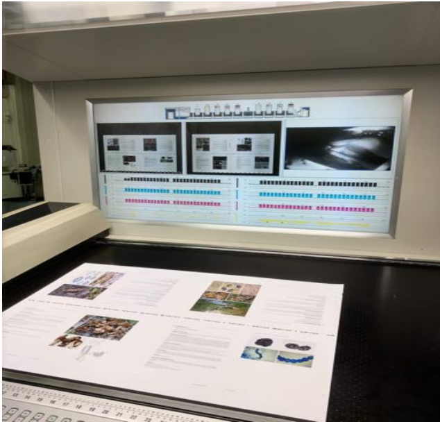
Die Schaltzentrale der Druckmaschine.
