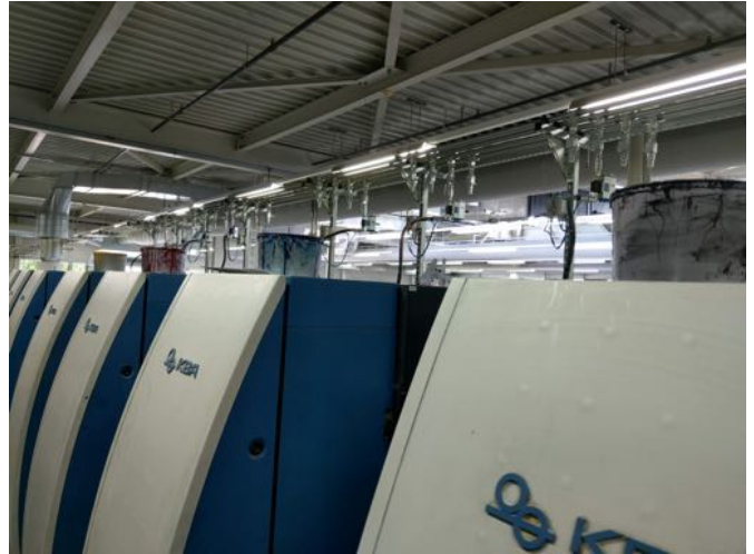
Die Druckmaschine druckt in acht Schritten: schwarz, blau, rot, gelb und dann die Rückseite in der gleichen Reihenfolge.
