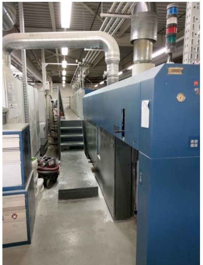
Das was ihr möglicherweise als Schmutz interpretiert ist kein Schmutz. Es ist «Druckpulver» und der ist sehr wichtig damit die Bögen nicht kleben und besser austrocknen.
